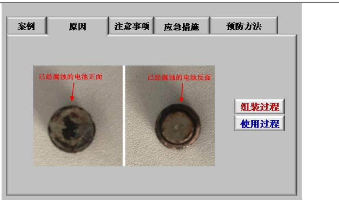
图 30 纽扣电池漏液问题仿真操作界面
